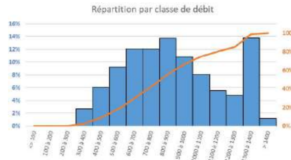
Histogramme des débits reconstitués en sortie du barrage d'Ottmarsheim entre 1994 et 2021 (DHI, 2021).
