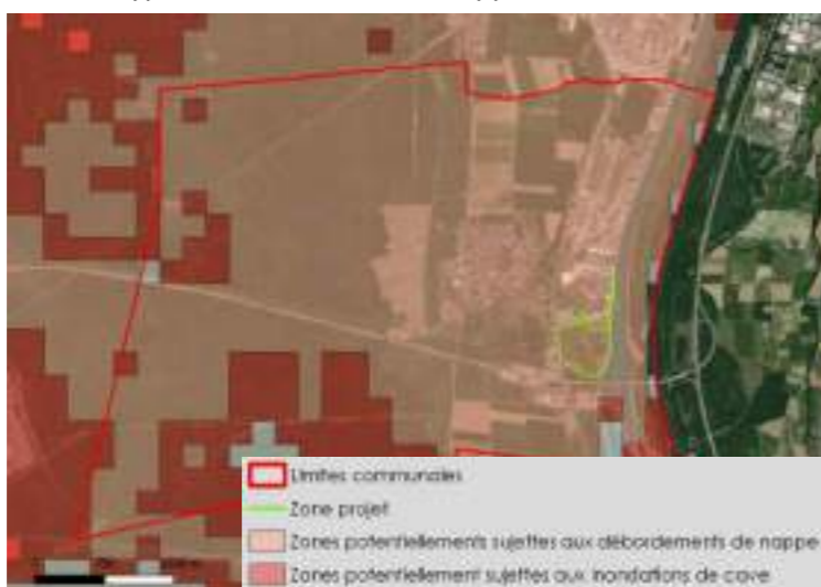
Risque de remontée de nappe au niveau de la commune d'Ottmarsheim (source : Géorisques)
